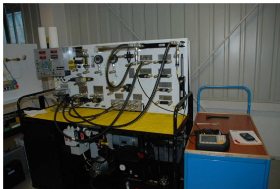
obr. 72: Zapojení obvodu pro měření odporové síly těsnění
